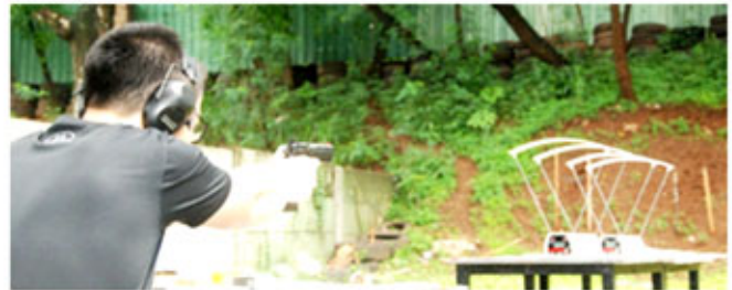
Gambar 1. Posisi peletakan alat untuk uji akurasi dan kecepatan proyektil
